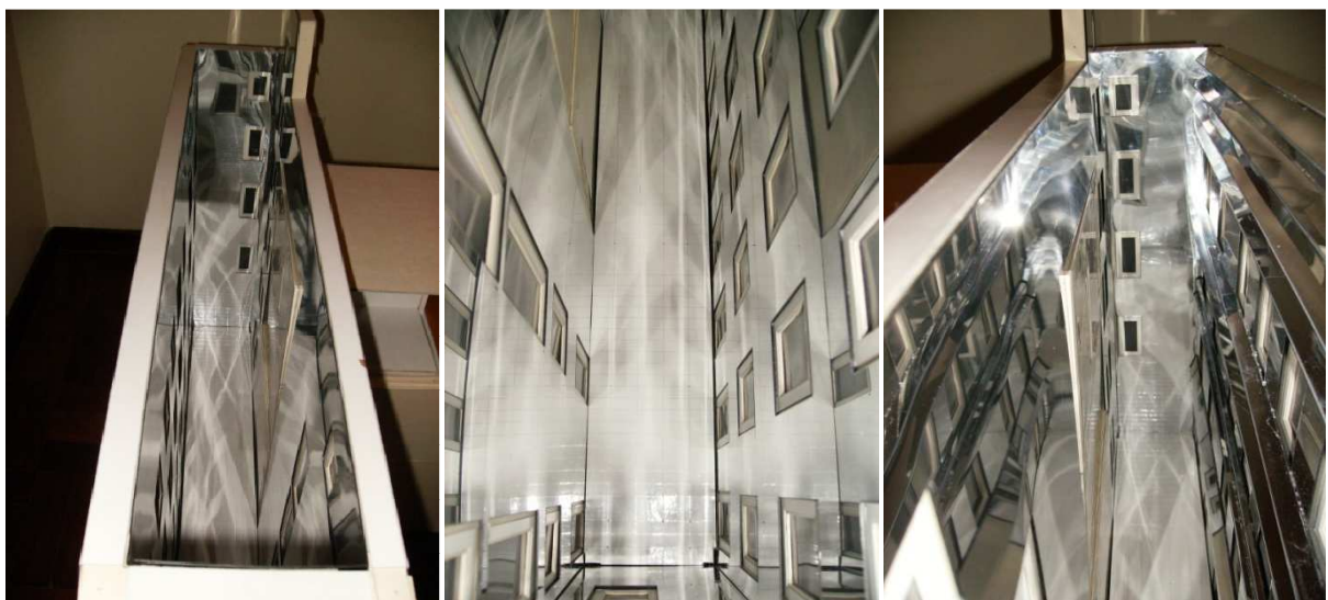
Figura 60 – Soluções propostas (da esquerda para a direita: fachada reflectora vertical, vista superior do saguão com fachada reflectora plana, fachada reflectora prismática)
